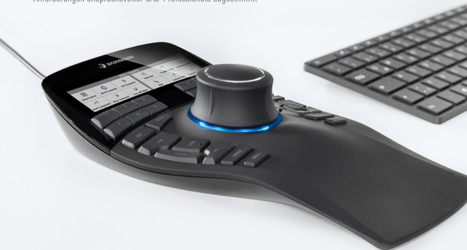
**Professionelle 3D-Navigation in CAD** – intuitive und präzise Navigation in digitalen Modellen oder Ansichten dank des patentierten Sensors mit 6 Freiheitsgraden (6DoF).
